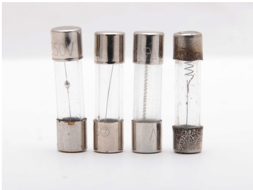
Рисунок 8 Предохранители. Слева направо: ускоренный, обычный, замедленный и сверхмедленный.
