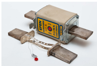
Рисунок 4 Промышленный предохранитель на 100А с внутренней конструкцией. Красный флажок выталкивается пружиной при сгорании плавкой вставки и пережигании фиксирующей проволоочки. Фото пользователя Medvedev с сайта Wikimedia Commons, CC BY-SA.
