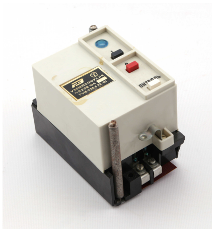
Рисунок 41 УЗОШ. Устройство защитного отключения школьное, произведено в СССР в 1980е годы. Конструктивно представляет собой электронное УЗО.
