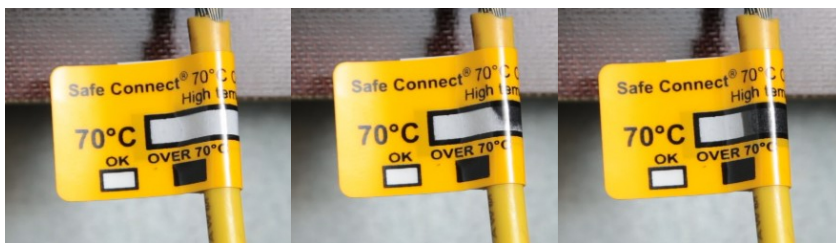
Рисунок 66 Процесс изменения цвета наклейки при нагреве от компании "Safe Connect".
