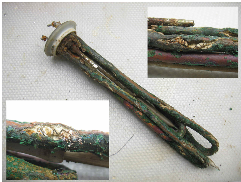
Рисунок 46 Прогнивший, потерявший герметичность ТЭН из бойлера, не защищённого УЗО. При наличии УЗО оно бы сработало на ранней стадии и пришлось бы диагностировать проблему, но этот ТЭН ещё долго работал, пока не сгнила спираль, а людей в ванне щипало током.
